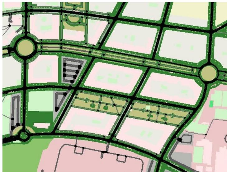
Figura 11: Composición del escenario para simular el tráfico vehicular en SUMO.
