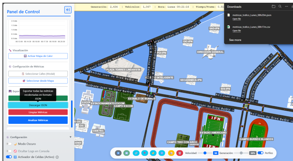
Figura 6.33: Prueba PM-07: Exportación de métricas en formato JSON
