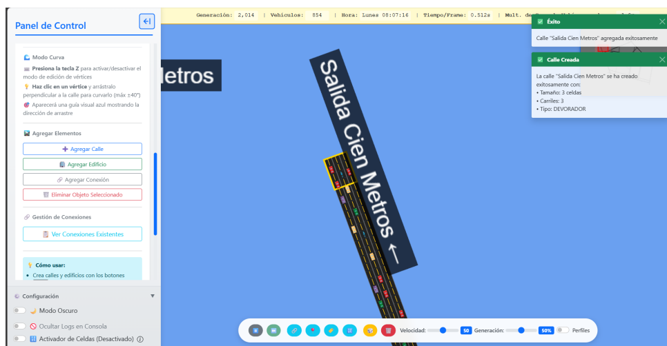
Figura 6.10: Prueba PF-09: Absorción de vehículos en calle tipo DEVORADOR
