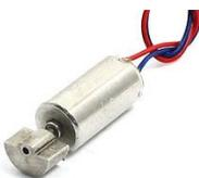
Debido al tamaño necesariamente pequeño de robot que exige el proyecto se ha optado por utilizar dos micro motores de vibración los cuales permitirán el movimiento y los giros requeridos en la implementación del algoritmo.
