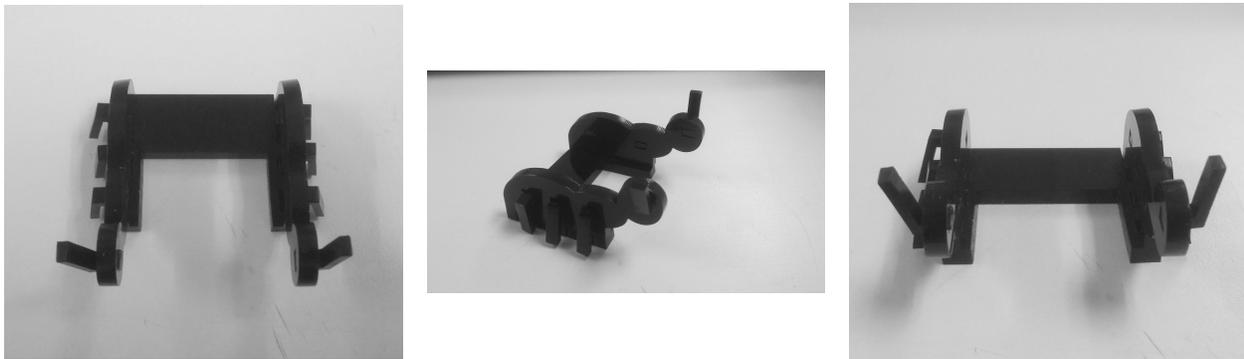
Figura 7.31: Perspectivas de una carcasa para un antBot
