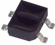
Con la finalidad de explorar su entorno, cada robot contará con dos sensores infrarrojos ubicados a cada lado del dispositivo. Esto le permitirá conocer su proximidad a objetos con el fin de evitar obstáculos. Debido a sus dimensiones (2.90mm por 3.60mm), el dispositivo propuesto es el sensor infrarrojo QRE1113, con una distancia óptima de sensado de 0.125 pulgadas equivalente a 3mm.
