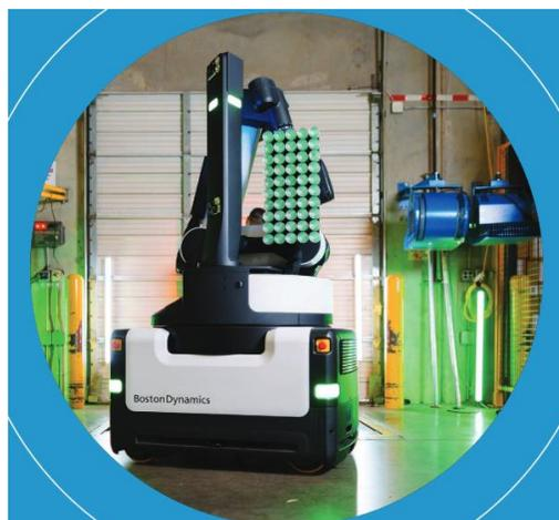
*Ilustración 6 Robot Stretch [8].*
