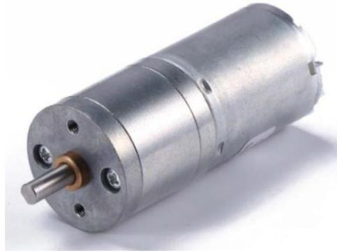
Ofrecen otra ventaja que es el de tener integrado un arreglo de codificadores con imán y sensores hall que permite contar 11 regiones del imán por cada vuelta que da el eje del motor.
