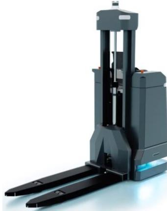
*Ilustración 5 Robot MiR1200 Pallet Jack [7].*
