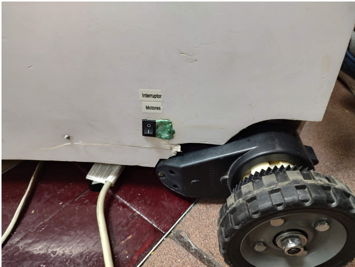
Figura 190: Etiqueta interruptor motores.
