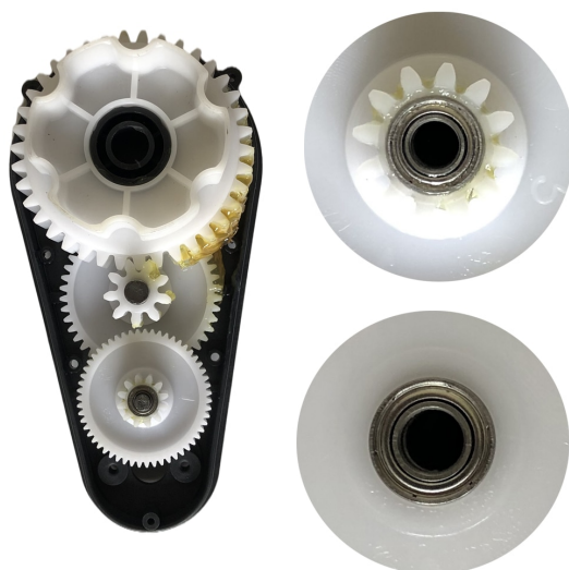
Figura 156: Engranajes que componen la caja de cambios para el motor RS-550. 8
