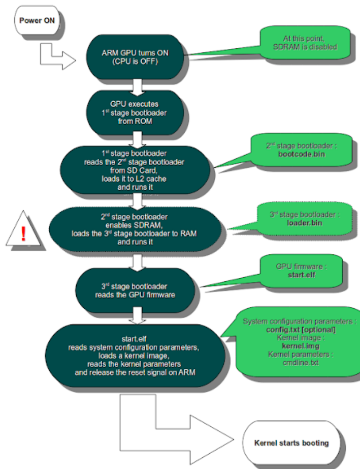
Figura 8: Sistema de arranque en Raspberry[28].
