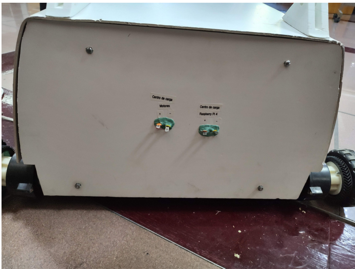
Figura 192: Etiquetas centros de carga indicando polaridad.
