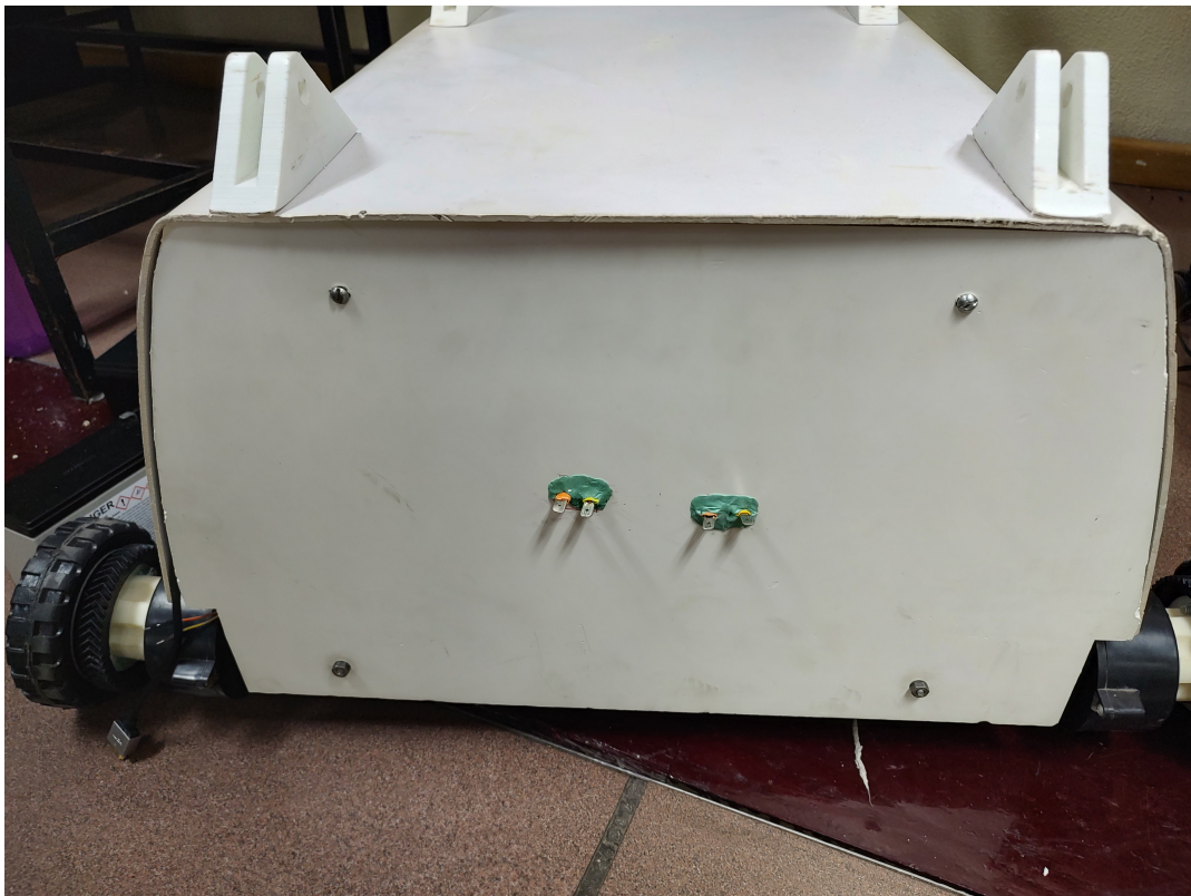
Figura 186: Centro de carga para las baterías del robot.
