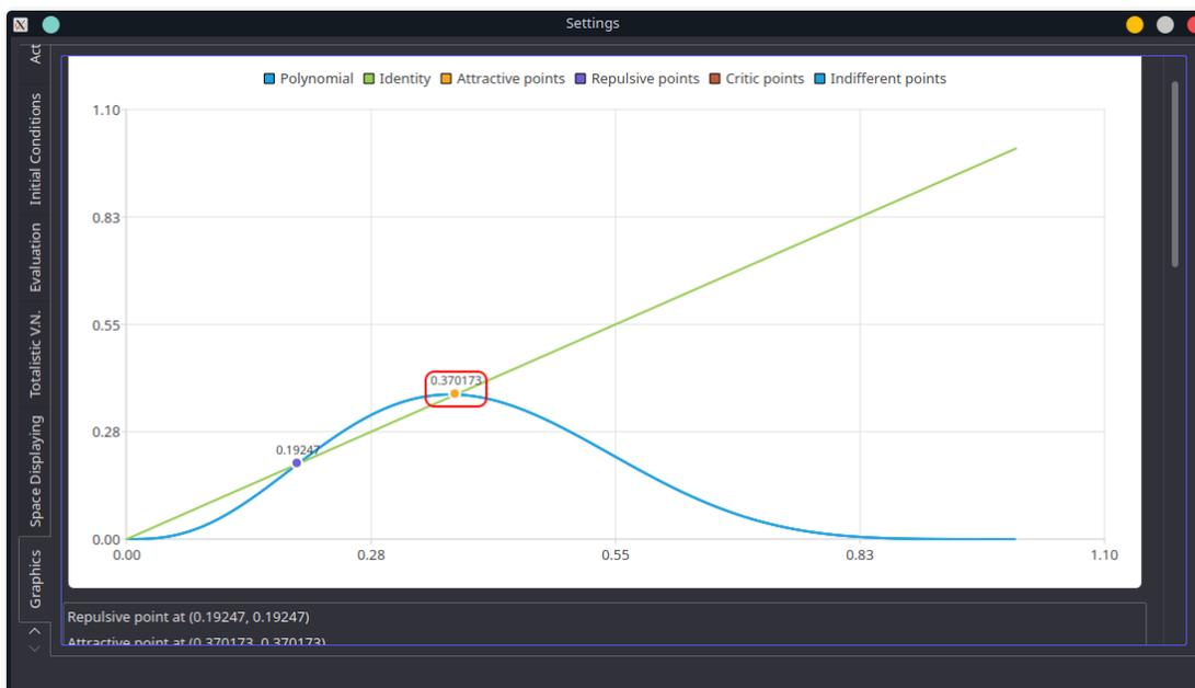
Fig. 6.1.56: IU-CU30.1 Gráfica del polinomio característico con puntos de intersección del tipo atractivo
