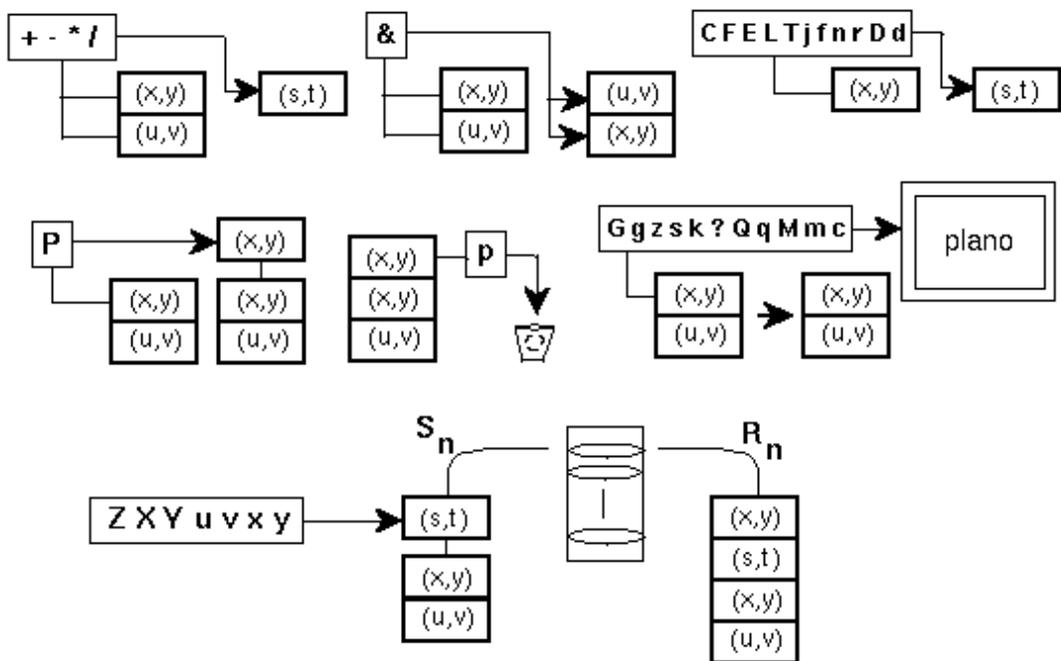
Figura 21: Flujo de datos sobre la pila REC/C
